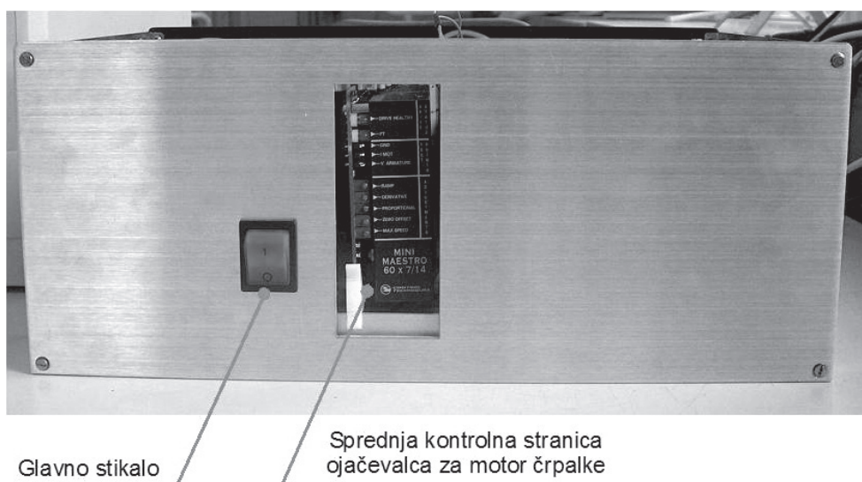
Slika 4: Krmilnik z ojačevalnikom za pogon motorja črpalke
